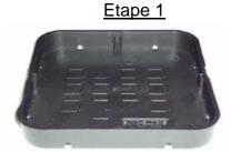
Une base en noire qui sert comme point de support et qui est fermé en bas. Les cotés sont légèrement perforés, ceci permet à l'eau de s'échapper du GUMO-BLOCK. Forme carrée en Polypropylène préfabriqué en dimension de 13cm sur 13cm et 2cm de hauteur.
